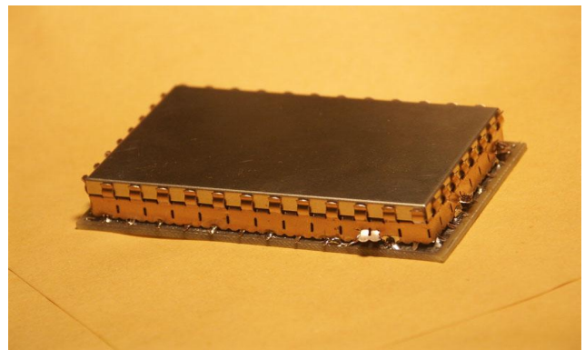
Vista esterna con schermatura
